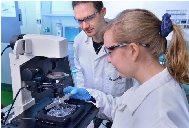
Bild 4: Forschende des Fraunhofer ILT erproben das LIFTOSCOPE für die KI-gestützte, vollautomatisierte Hochdurchsatzsortierung lebender Zellen mit gepulster Laserstrahlung. © Fraunhofer ILT, Aachen.
